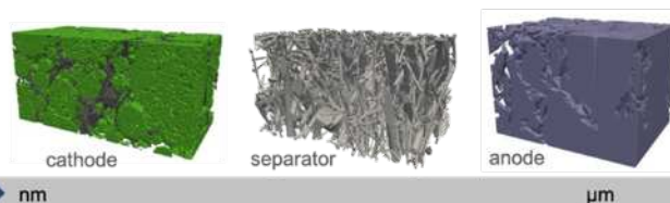
Mikrostruktur-Rekonstruktion einer realen Li-Ionen Batterie mittels Focus-Ion-Beam und Elektronenmikroskopie
