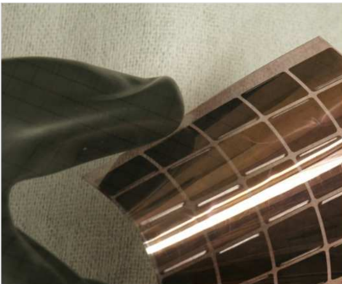
Flexibles Modul aus 25 organischen Solarzellen
