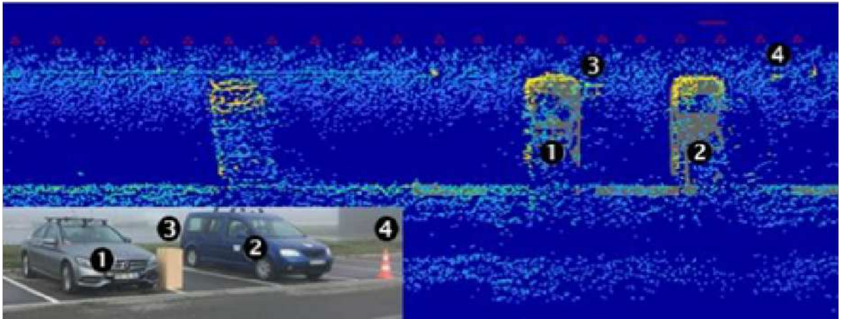
Parklückenausmessung mit hochauflösenden Radarsensoren (Bild: BMBF Projekt radar4FAD)
